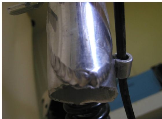
図11 フレームの破断箇所正面
