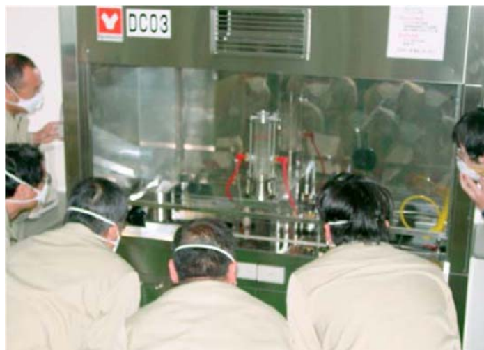
粉じん爆発実験の様子。潜在危険の発見能力と対処能力を同時に養うことを目的として「火災爆発体感研修」を実施。
